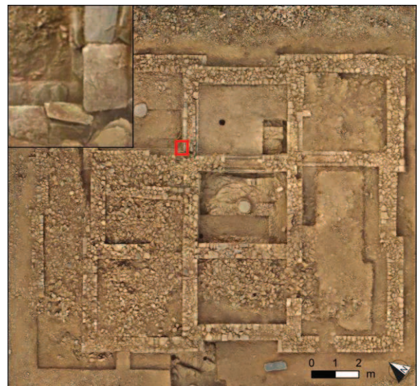
Figure 13 : Ortho-photo obtenu à partir de photos prises à l'aide d'une perche d'une maison d'époque aksumite à Wakarida (Éthiopie) : la résolution permet de distinguer nettement tous les matériaux de la construction.
