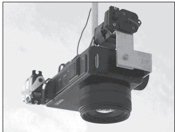
Figure 2 : Exemple de nacelle pour des clichés verticaux ; on distingue à gauche le servo-moteur qui actionne le déclenchement.
