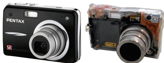
FIGURE 4: L'appareil photographique compact choisi avant (170g) et après (119g) amaigrissement.
