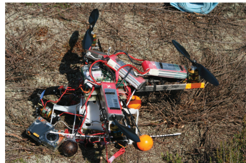
FIGURE 10: La rupture d'une hélice due à la chaleur a malheureusement eu raison de notre vecteur et de sa charge utile.
