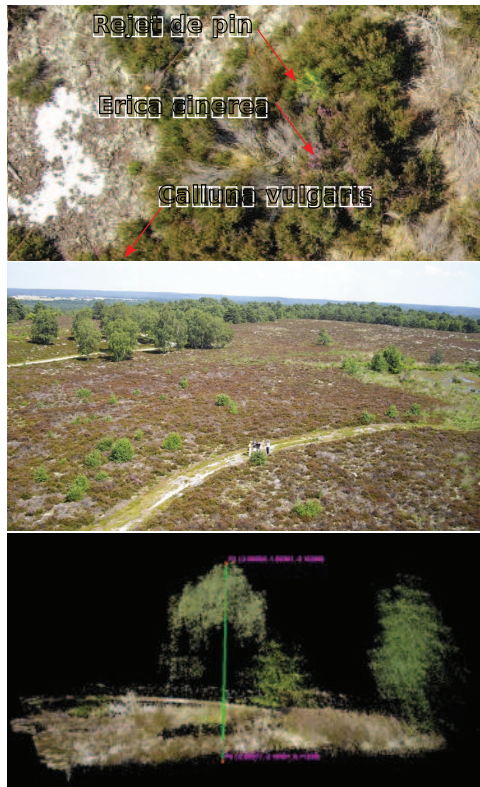
FIGURE 11: Exemple de données issue du capteur tri-caméras. En haut, identification précise des espèces ligneuses sur une portion d'orthomosaïque. Au milieu, image oblique permettant une vue d'ensemble de la zone d'étude. En bas, une reconstruction tri-dimensionnelle à partir d'un couple stéréoscopique.
