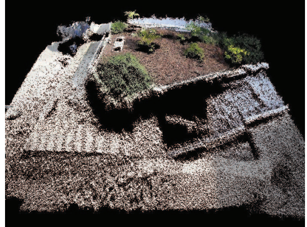
FIGURE 9: Exemple de couple stéréoscopique acquis avec le capteur tri-caméras et la restitution tridimensionnelle obtenue.
