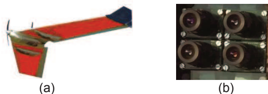
Figure 3 : Le drone AIRINOV® (a) et son capteur multispectral quadri-bandes : multiSPEC 4C (b).
