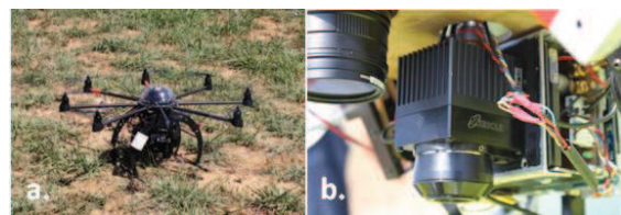
Figure 2 : Système d'acquisition d'images aériennes. a) Otkokopter, b) Caméra infrarouge thermique
