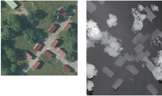
FIGURE 2: Comparaison d'une image aérienne (source IGN) et du MNE obtenu à partir de données Lidar mises en géométrie commune à l'aide des mesures brutes délivrées par le système de navigation. L'inconsistance de ces mesures produits des bâtiments fantômes autour du carrefour.
