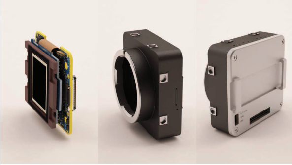
Figure 6 : vue en images de synthèse de l'étage imageur sans optique
