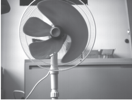
Figure 3 : effets indésirables d'un rolling shutter dans le cas d'un objet mobile (source : internet[1])
