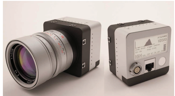
Figure 9 : vue en images de synthèse de la configuration avion (association étage imageur-module avion), avec une optique Leica
