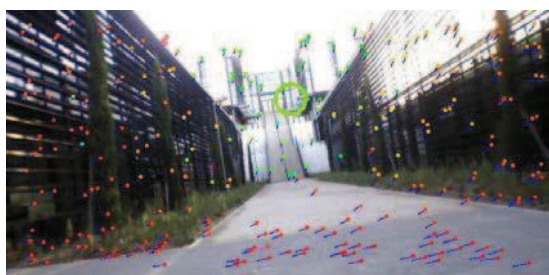
Figure 6 : Reconstitutions 3D éparses : les lignes bleues/violettes montrent des vecteurs de flot optique cohérent/en conflit avec le mouvement de la caméra.
