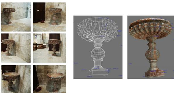
**Figure 5 :** Reconstruction en 3D du bénitier par photomodélisation, à partir de photos convergentes calibrées et orientées (De Luca, 2009).
