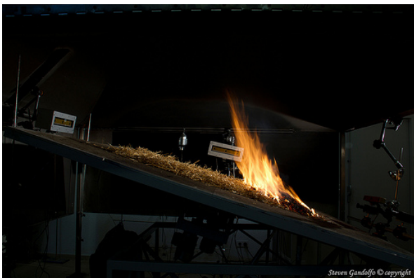
FIGURE 13 : Plateau incliné à 20^\circ sur lequel a été faite la propagation du feu dont l'évolution temporelle de position est présentée en figure 9.
