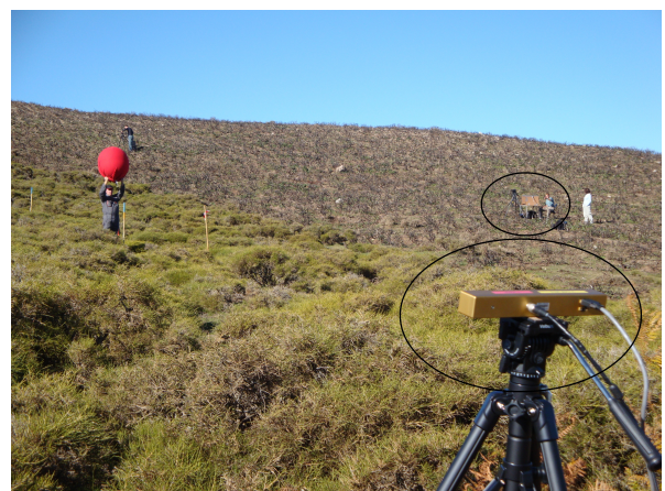
FIGURE 20 : Caméras XB3 (dans cercle) autour d'une zone de propagation.
