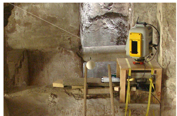
FIGURE 15 : Une sphère et son lest, en arrière-plan, le scanner en station sur un arc. Cliché L. Borel ©CEAlex.
