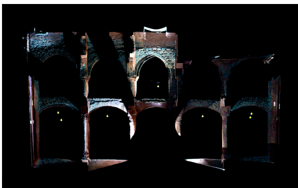
FIGURE 16 : Exemple d'un nuage de points brut du volume intérieur obtenu avec le scanner en station horizontale. L. Borel ©CEAlex.
