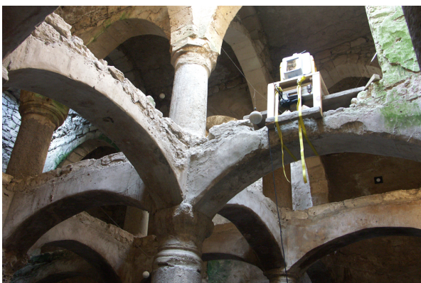
FIGURE 13 : Scanner en station sur le «chevalet» durant l'acquisition du niveau supérieur. Cliché L. Borel ©CEAlex.
