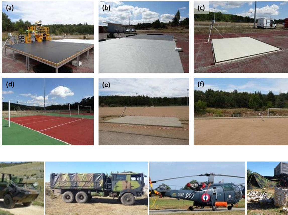
**FIGURE 3: Cibles utilisées lors des campagnes de mesures aéroportées. (a-f)** Surfaces de référence au sol pour des mesures de vérité terrain : (a) panneaux noirs et blancs, (b) panneaux de linoléum, (c) panneaux de polystyrène, (d) béton peint, (e) sable, (f) argile. **(g)** Exemples de cibles militaires utilisées durant une campagne.
