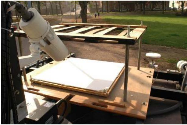
FIGURE 12 : Dispositif permettant de mesurer l'éclairement solaire avec un spectralon en utilisant le bord des ombres.
