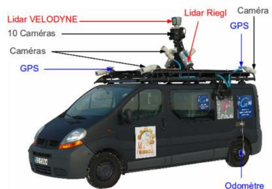
FIGURE 11 : Les différents instruments embarqués sur le système de cartographie mobile Stereopolis.
