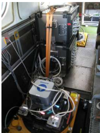
FIGURE 6 : Photo du montage du système IGN : 8 caméras multispectrales et panchromatiques avec la centrale inertielle et les deux racks d'acquisition.
