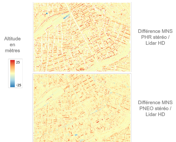
FIGURE 9: Différences altimétriques MNS PHR / LiDAR HD® et MNS PNEO / LiDAR HD® pour la classe "sol".
