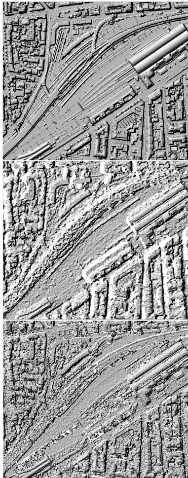
FIGURE 11: Visualisation des MNS sur la zone de la gare de Nice. En haut : MNS LiDAR HD@. Au milieu : MNS PHR. En bas : MNS PNEO.
