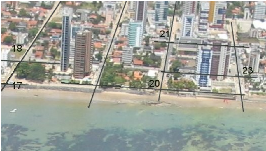
Figura 5 : Trecho de fotografia com os eixos de ruas traçados para facilitar a identificação de pontos de ligação.
